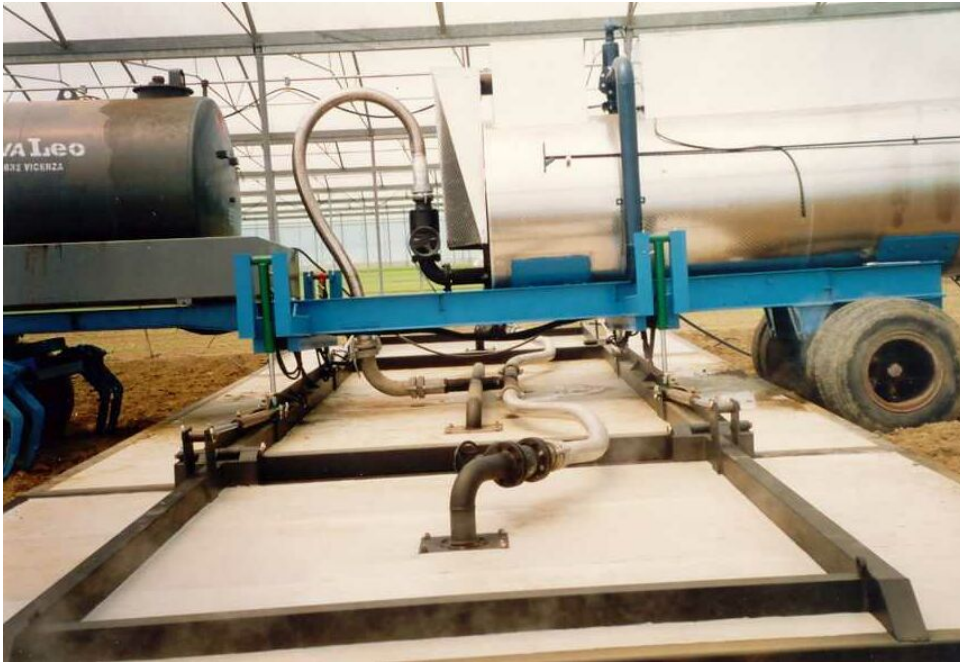
Abb. 3-10: 3-geteilte Dämpfhaube (Länge 3 x 4 m, Breite 5 m und somit 60 m 2 ) mit Dampfkessel ( 2.000 kg/h) (Werkbild Möschle)
