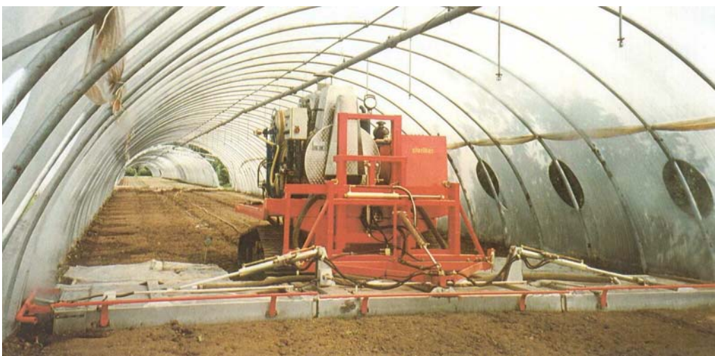
Abb. 3-11: Mobile Dämpfeinheit ohne Fahrer Steriliter S 500 (Werkbild Möschle – Ferrari)
