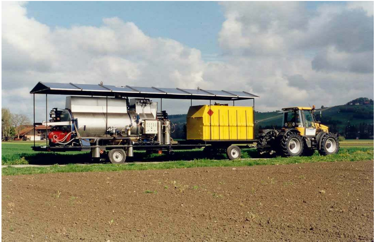
Abb.3-2: Mobile Dämpfeinheit mit Dampfkessel (2 000 kg/h) und Ölbehälter für 24-StundenBetrieb (Werkbild Möschle)
