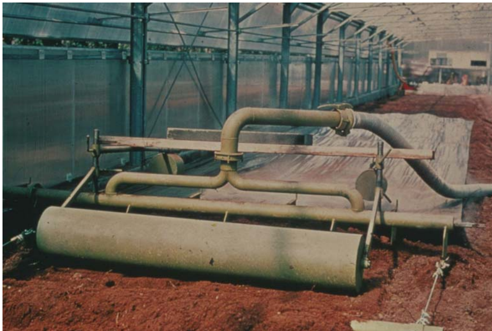
Abb. 3-14: Dämpfpflug mit Seilzug und Schleppfolie im Gewächshaus
