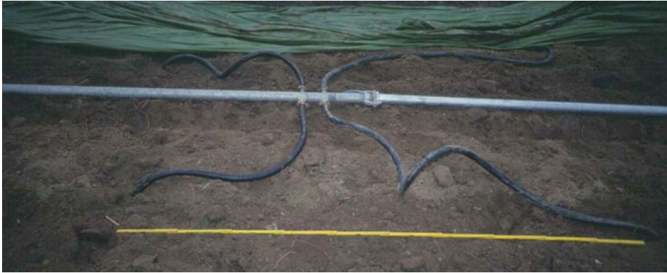
Abb. 3-17: Unterdruckdämpfen nach dem System Fink (im Rahmen einer messtechnischen Überprüfung)
