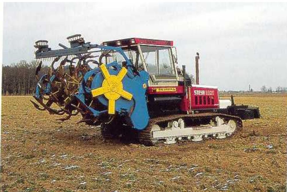
Abb. 3-33: HAB Tiefspatenfräse Type 120 Arbeitsentiefe 120 cm, Arbeitsbreite 275 cm, Durchmischung 10-50% (Werkbild Aerts)
