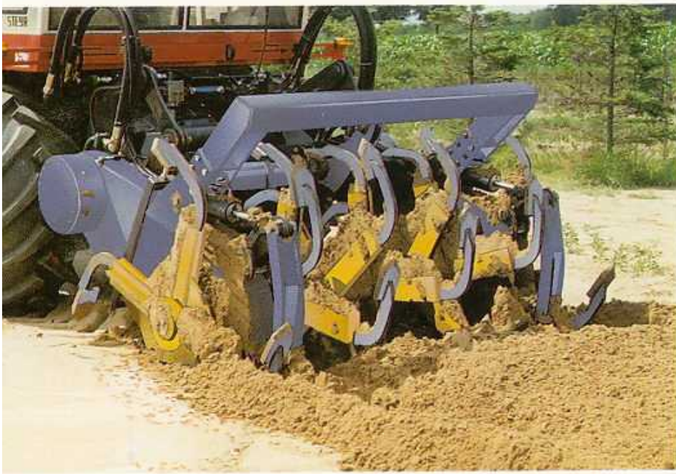
Abb. 3-32: HAB Tiefspatenfräse Arbeitsentiefe 30 bis 120 cm, Arbeitsbreite 150 bis 270 cm (Werkbild Aerts)
