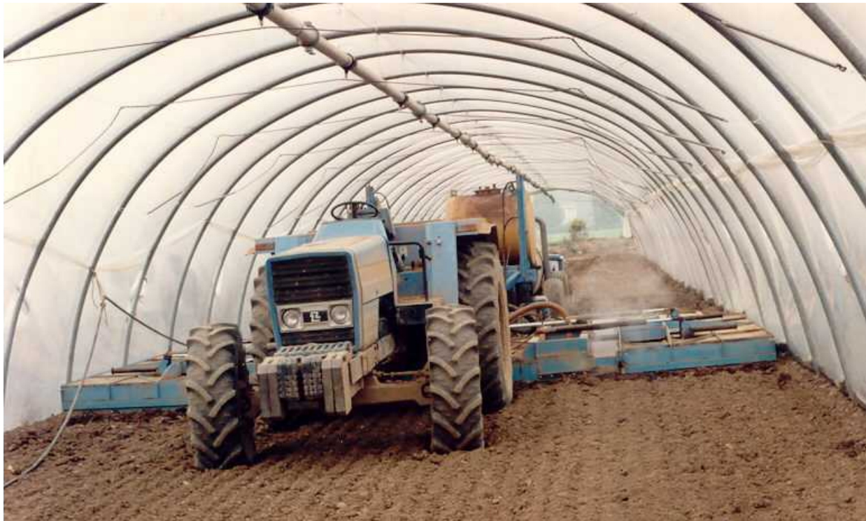
Abb. 5-2: Mobile Dämpfeinheit mit Fahrer (Werkbild Möschle)
