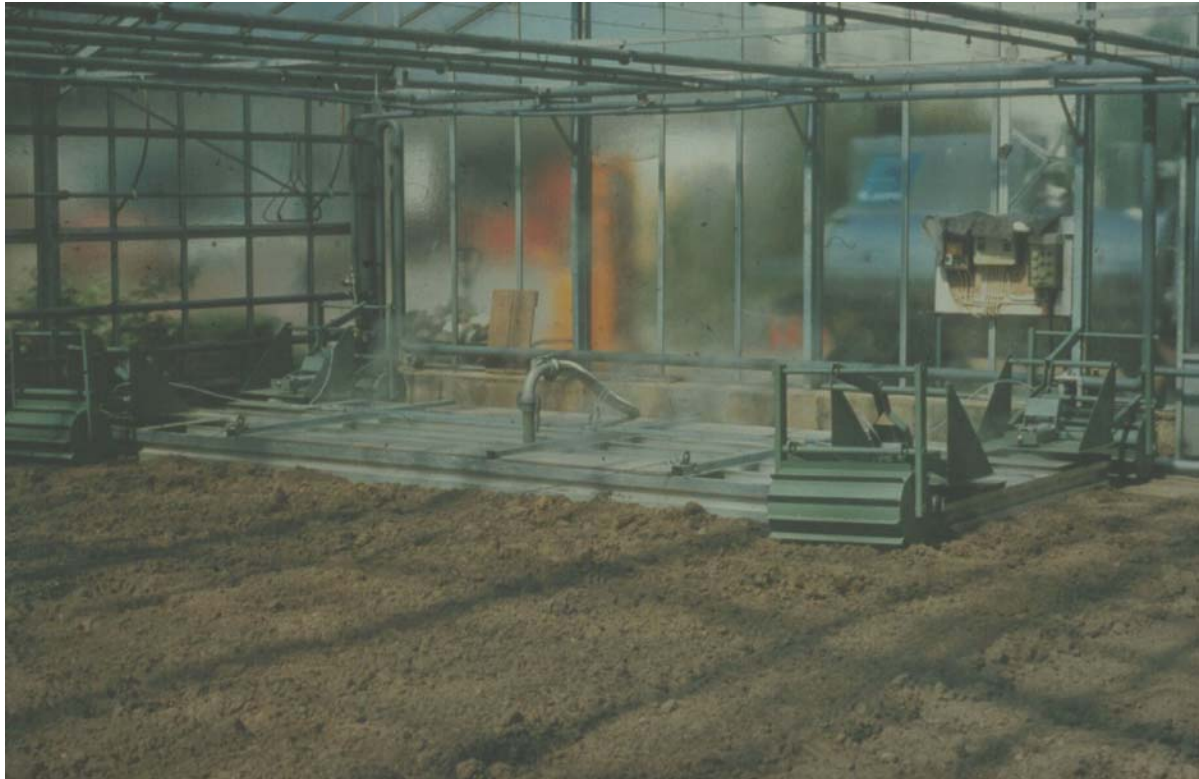
Abb. 3-9: Dämpfhaube, die mit Seilwinde im Gewächshaus transportiert wird
