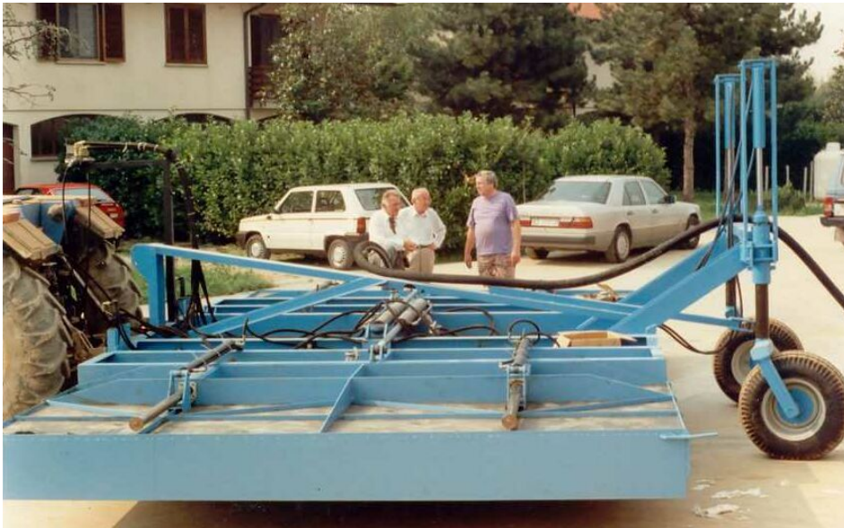
Abb. 3-13: Verstellbare Dämpfhaube (Möschle)
